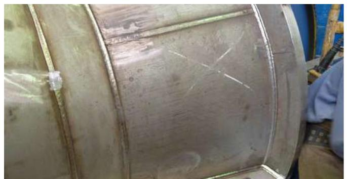
Bomba de agua de mar de acero inoxidable dúplex UNS S32205 soldada con Avesta FCW 2507/P100-PW (E2594T1-4/1) para la mayor resistencia a la corrosión posible.
