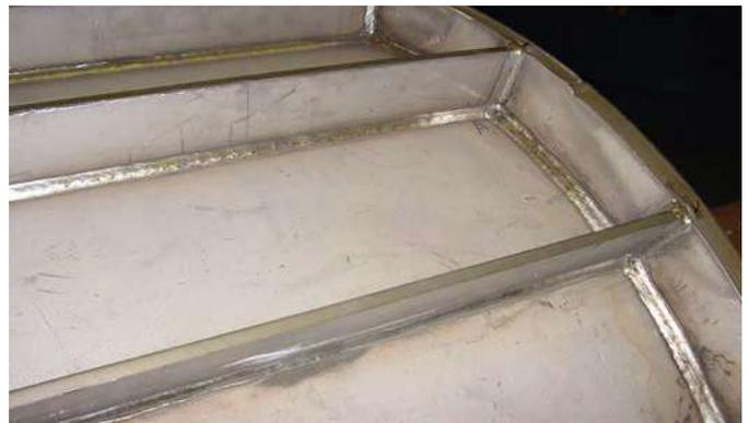
Soldaduras en ángulo lisas y brillantes. La aplicación es un eje para un filtro de discos de la industria de la pulpa y el papel. El metal base es AISI 316Ti y el hilo es BÖHLER EAS 4 M-FD (E316LT0-4/1).
