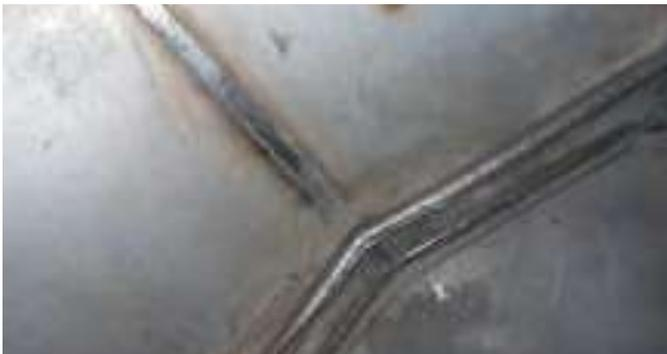
Soldeo de UNS S32205 en posición vertical ascendente y bajo techo utilizando Avesta FCW 2205-PW (E2209T1-4/1).
