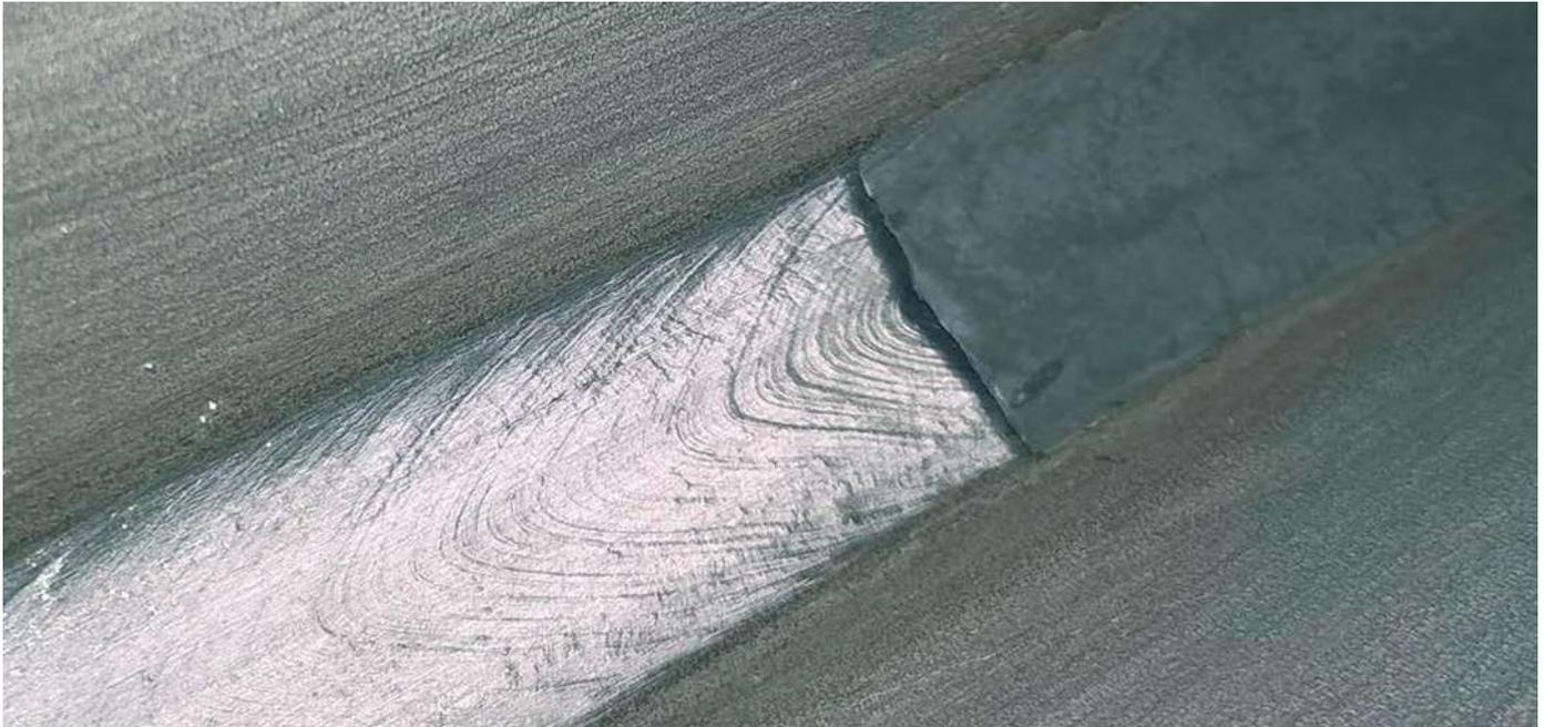
En el proceso FCAW, el baño de fusión se protege mediante escoria y gas de protección. La escoria cubre la superficie del cordón de soldadura así como la cara opuesta de la raíz, esto lo convierte en un proceso muy adecuado para el soldeo por un solo lado en campo (trabajo en exteriores). La escoria de rutilo es la más utilizada y se aplica en dos tipos: de enfriamiento rápido y de enfriamiento lento.
