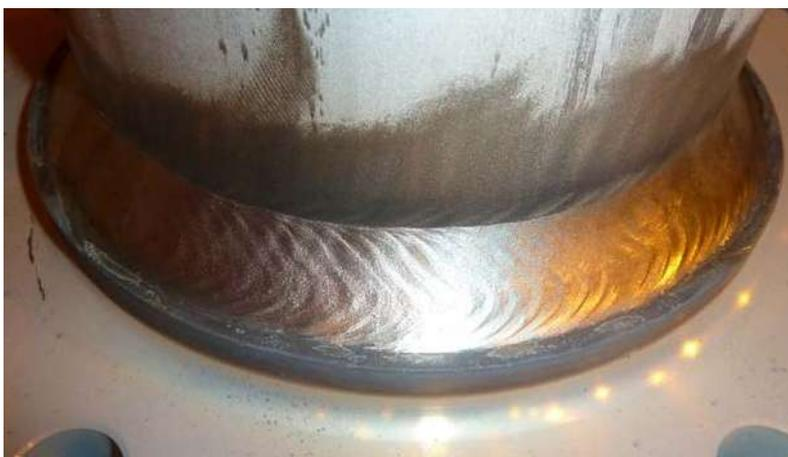
Soldadura en ángulo en posición plana (PB/2F). El metal base es AISI 304L y el metal de aportación es Avesta FCW-2D 308L/MVR (E308LT0-4/1). Ø 1,2 mm.
