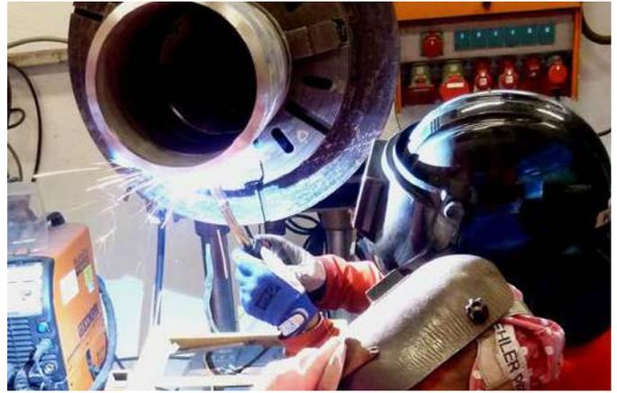
Soldeo de tubo de acero superdúplex UNS S32750 utilizando Avesta FCW 2507/P100-PW NOR (E2594T1-4/1).
