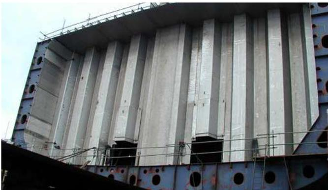
Tanques de carga en un buque cisterna fabricados con UNS S32205 y soldados con gas de protección 100% CO<sub>2</sub>. Las soldaduras en posiciones plana y horizontal se han realizado con Avesta FCW-2D 2205 (E2209T0-4/1) con respaldo cerámico para la pasada de raíz. Para las soldaduras en posición se ha utilizado Avesta FCW 2205-PW (E2209T1-4/1). Para las soldaduras disimilares se utiliza Avesta FCW-2D 309L (E309T0-4/1) y Avesta FCW 309L-PW (E309T1-4/1).
