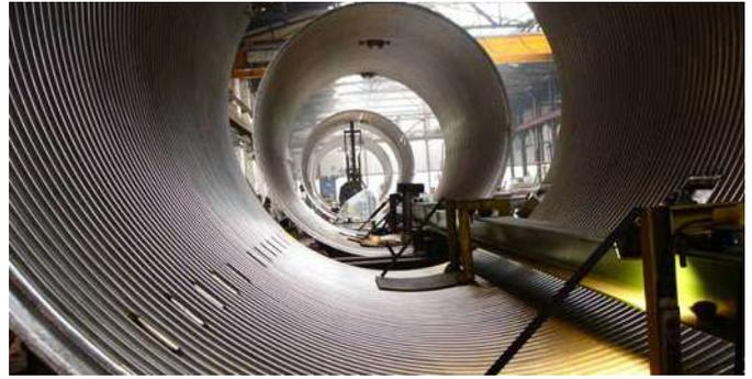
Soldeo de serpentines de Ø 1,2 mm utilizando BÖHLER EAS 4 M-MC (EC316L). Cortesía de Neuman Anlagentechnik, Alemania
