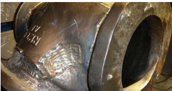
Avesta FCW 2507/P100-PW NOR (E2594T1-4/1) utilizado para la reparación por soldeo de fundición de acero inoxidable superdúplex.
