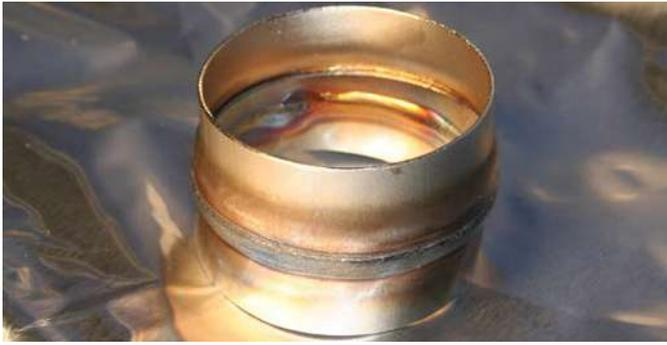
Colector de escape de 0,6 mm soldado con Ø 1,2 mm BÖHLER EAS 2-MC (EC308L). Velocidad de alimentación de alambre 2,6 m/min, 80-85 A, 20 V y velocidad de soldeo 85 cm/min. No fue posible utilizar hilo macizo para esta aplicación de chapa metálica.
