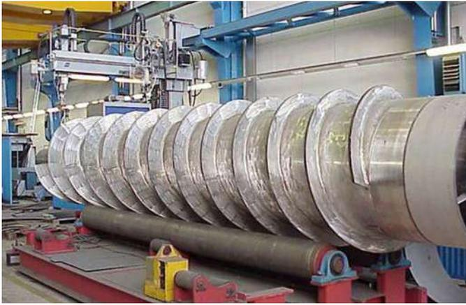
Eje sin fin para la industria de la pulpa y el papel fabricado con AISI 316Ti y soldado con Ø 1,2 mm BÖHLER EAS 4 M-FD (E316LT0-4/1). Cortesía de Andritz AG, Austria.
